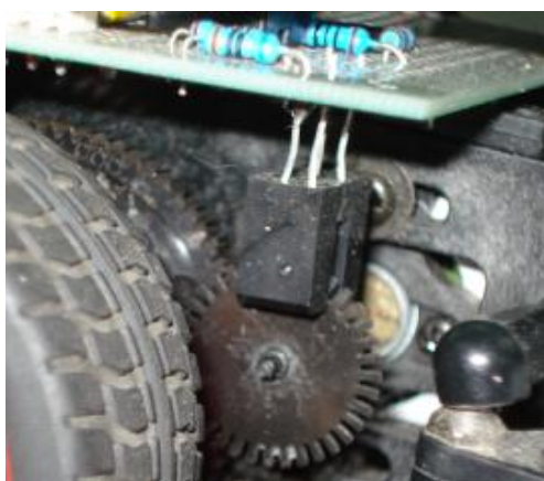
图 6.3 透射式光电检测电路的安装
