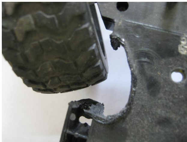
图 2.3 增加车轮转角的方法
