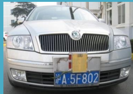
77GHz车载防撞雷达 行车试验安装图
